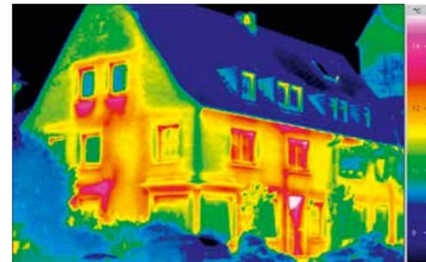
Aufnahmen mit der Wärmebildkamera helfen, Wärmebrücken am Haus zu entdecken. Foto: Verband Privater Bauherren e. V./ Bundesverband Deutscher Baustoff-Fachhandel e. V.
