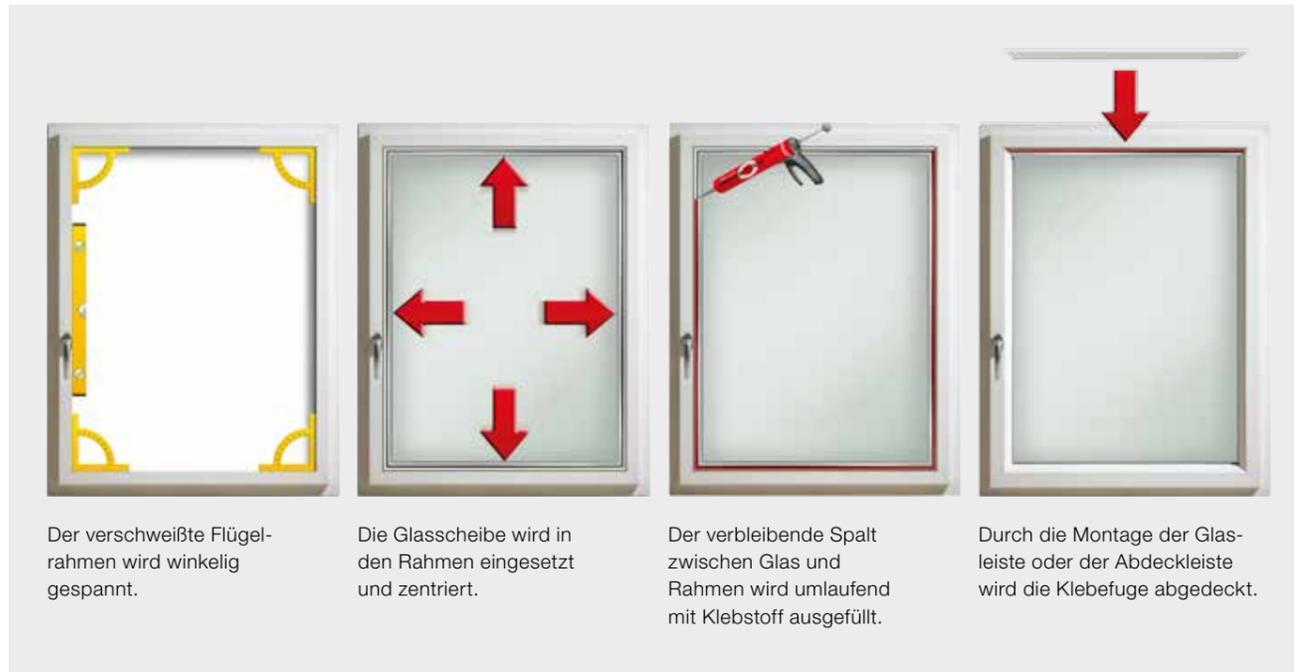
Der verschweißte Flügelrahmen wird winkelig gespannt.
