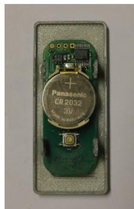
Batterie aus dem Bedienteil herausnehmen, Neue einsetzen, Cover wieder aufsetzen und nach unten schieben.
