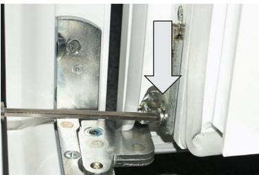
Anpressdruckverstellung mit Inbusschlüssel SW4.
