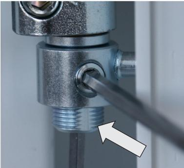
Vor Festziehen der Sicherungsschraube darauf achten, dass diese auf die abgeflachte Stelle der Höhenverstellungsschraube trifft, ansonsten wird das Gewinde beschädigt.
