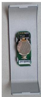
Alte Batterie herausnehmen, Neue einsetzen und die Abdeckung aufdrücken.
