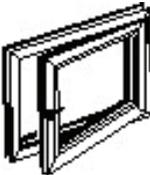
Lassen Sie den Fenstergriff in Kippstellung, drücken Sie den Flügel auf der Scherenseite an den Rahmen und drehen Sie den Griff (90°) in die Drehstellung.
